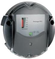
Ce module permet l'enregistrement des données (p.ex. valeurs de mesure et de bilan du système de chauffage solaire) pendant un laps de temps plus long. La mémoire interne est configurable et consultable au travers du navigateur Internet standard avec l'interface Web intégrée ou pour le logiciel RESOL Service Center.
