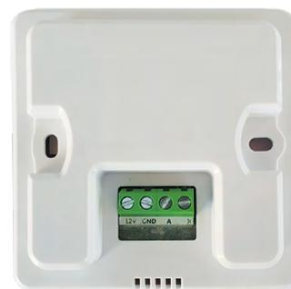
Un câble de connexion à l'unité intérieure de 5 m est fourni avec la télécommande. Le raccordement s'effectue de la manière suivante.
