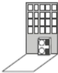
Le module placé contre un mur : + 3 dB(A)
