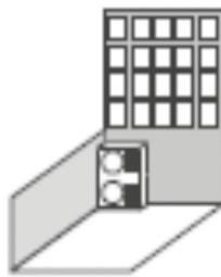
Le module placé dans un coin : + 6 dB(A)
