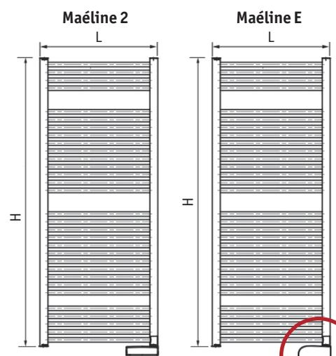
Maéline E est équipé d'un thermostat programmable qui vous permet de gérer selon vos envies et vos besoins la température désirée au moment souhaité. Il possède différents modes tels que « confort », « nuit », « boost » ou encore « arrêt » en cas d'ouverture de fenêtre. L'écran couleur vous indique en permanence le mode de fonctionnement et vous permet la programmation simple et efficace de votre sèche-serviettes.
