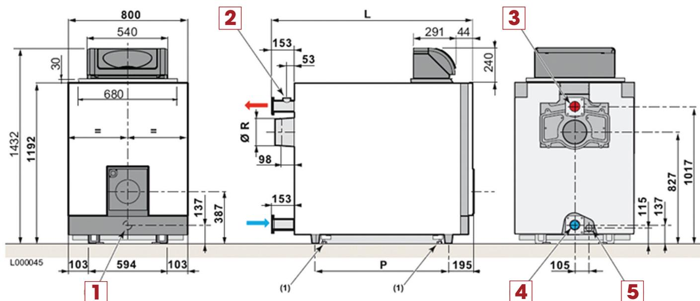
**1** Orifice de chasse Rp 2" 1/2 (bouchonné)
