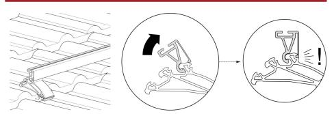
Système d'emboîtement par clips de la patte et du rail pour minimiser les outils et les risques liés au travail en hauteur.
