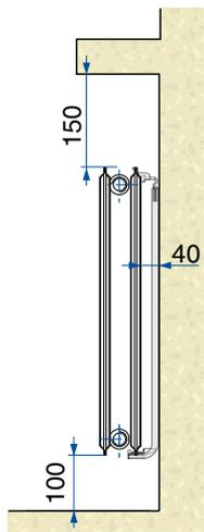
Le radiateur doit être placé au minimum à 2,5 cm du mur (ce qui est le cas avec les systèmes de fixation fournis avec nos radiateurs) et à 10 cm minimum du sol (15 cm dans le cas des verticaux avec vanne multifonctions) (la puissance peut chuter de l'ordre de 10 % par cm de moins).
