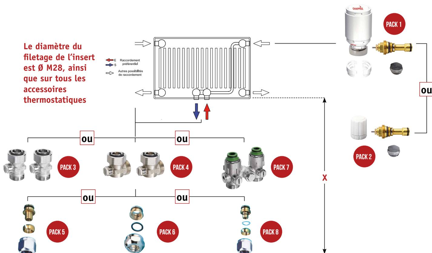
**NOTA :** Pour permettre le démontage éventuel du radiateur sans vidanger l'installation, utiliser des vannes d'isolation droites ou coudées avec mamelons de raccordement incorporés (PACK 3 ou 4) et les raccords pour tubes PER (PACK 5) ou tube cuivre (PACK 6).
