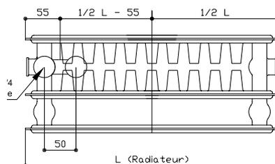
**NOTA :** Pour permettre le démontage éventuel du radiateur sans vidanger l'installation, utiliser des vannes d'isolation droites ou coudées avec mamelons de raccordement incorporés (PACK 3 ou 4) et les raccords pour tubes PER (PACK 5) ou tube cuivre (PACK 6).
