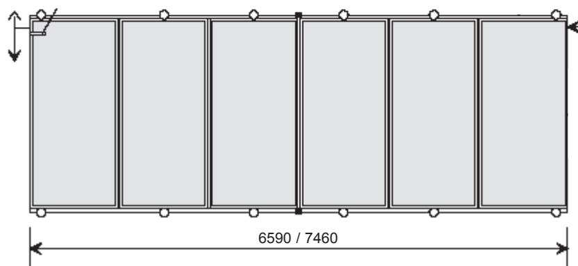
Montage 8 capteurs : Respecter le schéma ci-dessous avec raccordement parallèle des 2 champs de 4 capteurs (réseau équilibré).
