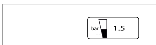
Fig.11 Pression de l'installation affichée à l'écran
