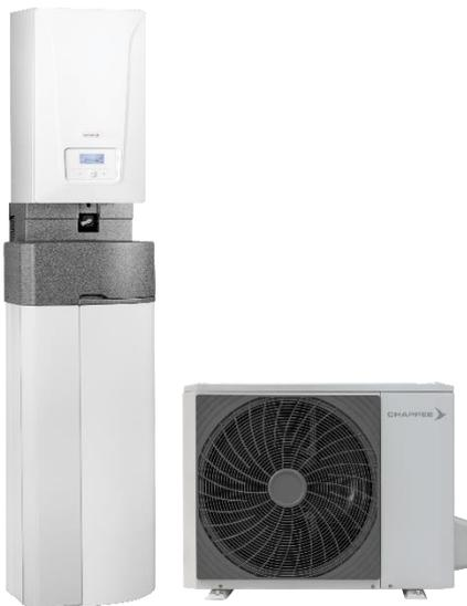
Le chauffage, la production d'eau chaude sanitaire ainsi que le rafraîchissement seront assurés par une pompe à chaleur de type air / eau compact. L'encombrement de l'unité intérieure est de 2244 mm (hauteur) x 553 mm (largeur) x 557 mm (profondeur). Ces dimensions prennent en compte l'unité intérieure, le kit hydraulique multifonction et le préparateur ECS. La fonction rafraîchissement est à activer à la mise en service.
