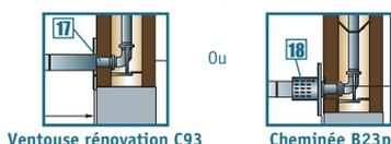
En installation cheminée, respecter les ventilations haute et basse du local chaufferie et la ventilation cheminée
